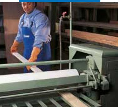
Application au rouleau d'Adesivil D3 pour assemblage d'éléments en bois
